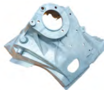
Eine Aluminiumguss-Federbeinaufnahme dient als Referenzbauteil.
